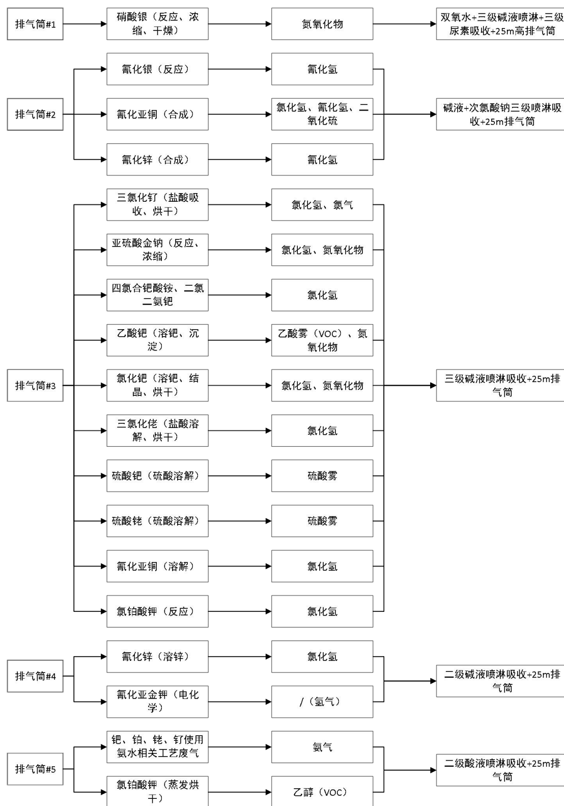
图 4.1-3 一期验收有组织废气收集、处理示意图
