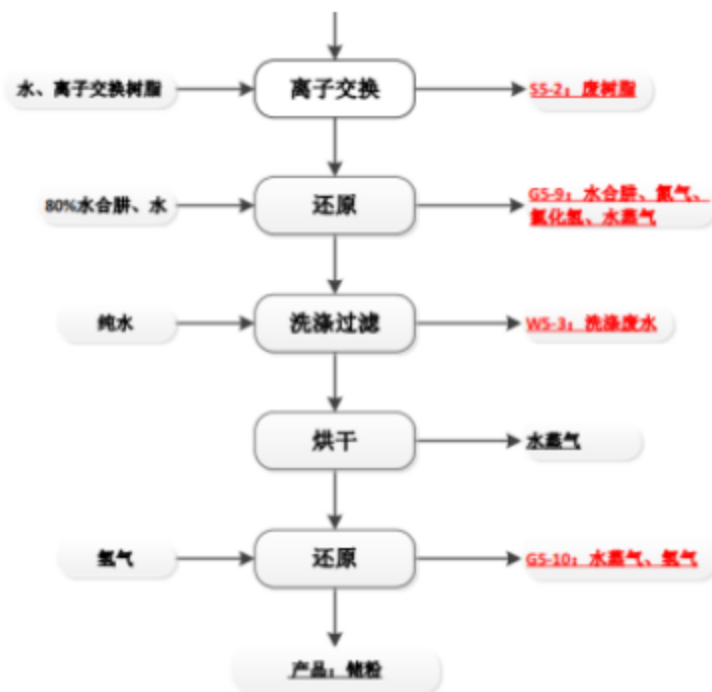
图 3.7-6 废铑催化剂综合利用生产线工艺流程图
