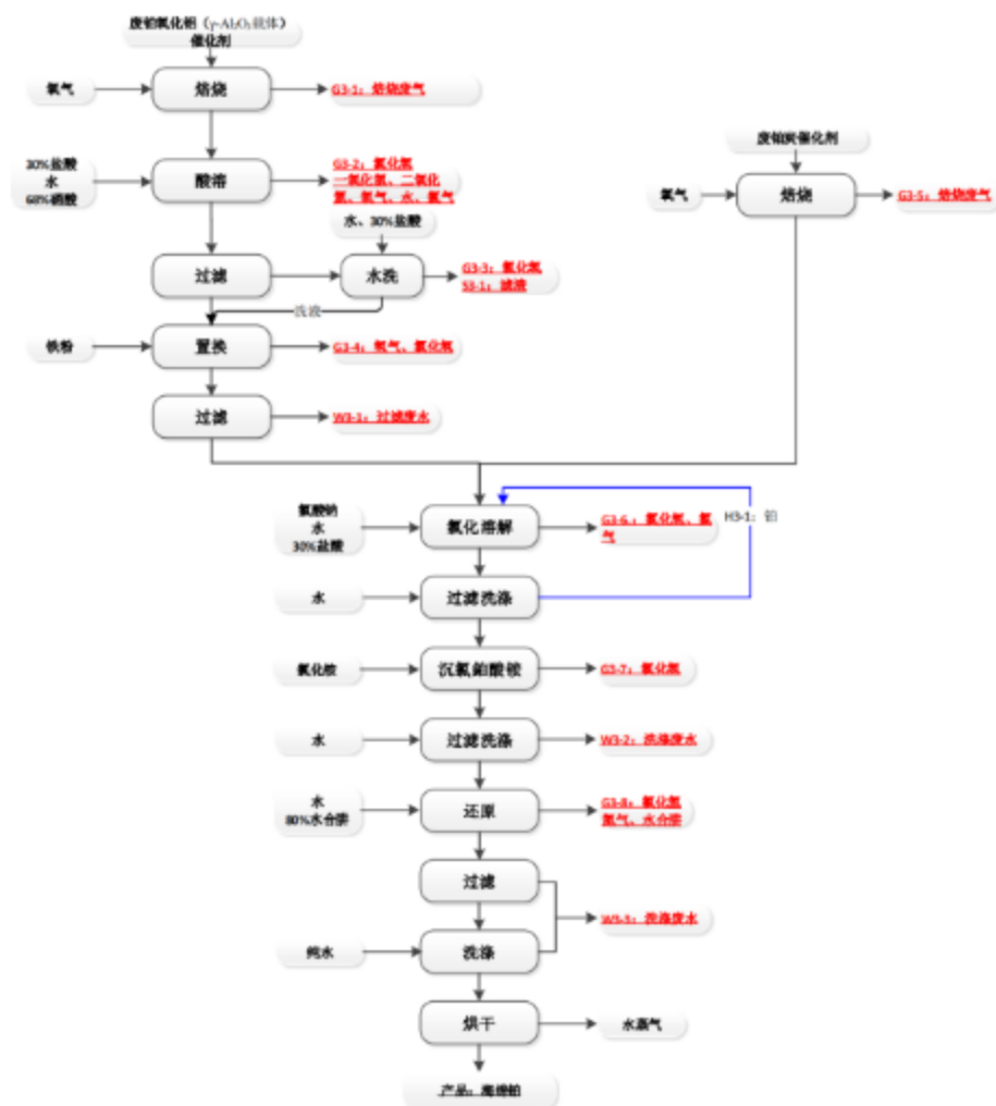
图 3.7-3 废铂炭催化剂和废铂氧化铝催化剂综合利用生产线工艺流程图
